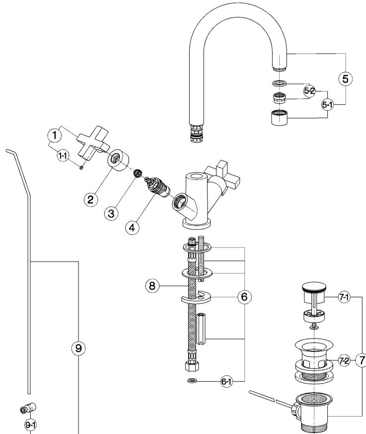
\* con resistenza silenziosa della classe di portata A (15 l/min. a 3 bar)
