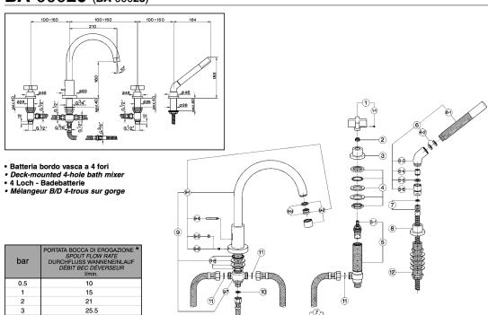
\* con resistenza silenziosa della classe di portata C (30 l/min. a 3 bar) with hydraulic resistance of flow rate class C (30 l/min. at 3 bar) mit geräuscharmen Widerstand der Durchflussklasse C (30 l/min. bei 3 bar) avec aérateur classe C (30 l/min. à 3 bar)
