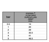
senza resistenza silenziosa (uscita libera) without hydraulic resistance ohne Widerstand sans résistance hydraulique
