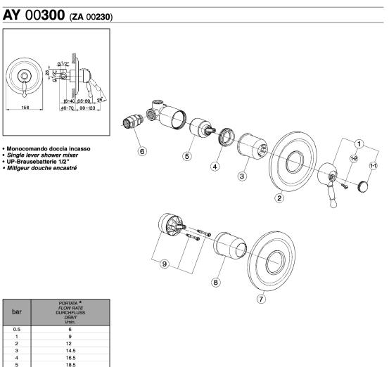
\* con resistenza silenziosa della classe di portata A (15 l/min. a 3 bar) with hydraulic resistance of flow rate class A (15 l/min. at 3 bar) mit geräuscharmen Widerstand der Durchflussklasse A (15 l/min. bei 3 bar) avec aérateur classe A (15 l/min. à 3 bar)
