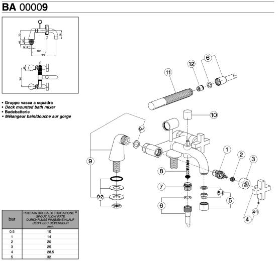
\* con resistenza silenziosa della classe di portata C (30 l/min. a 3 bar) with hydraulic resistance of flow rate class C (30 l/min. at 3 bar) mit geräuscharmen Widerstand der Durchflussklasse C (30 l/min. bei 3 bar) avec aérateur classe C (30 l/min. à 3 bar)
