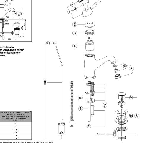
\* con resistenza silenziosa della classe di portata A (15 l/min. a 3 bar) with hydraulic resistance of flow rate class A (15 l/min. at 3 bar) mit geräuscharmen Widerstand der Durchflussklasse A (15 l/min. bei 3 bar) avec aérateur classe A (15 l/min. à 3 bar)
