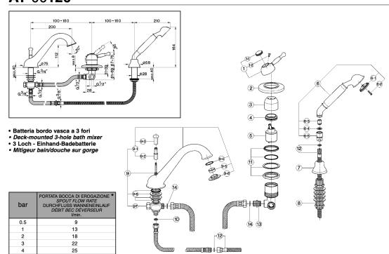
\* con resistenza silenziosa della classe di portata C (30 l/min. a 3 bar) with hydraulic resistance of flow rate class C (30 l/min. at 3 bar) mit geräuscharmen Widerstand der Druchflussklasse C (30 l/min. bei 3 bar) avec aérateur classe C (30 l/min. à 3 bar)
