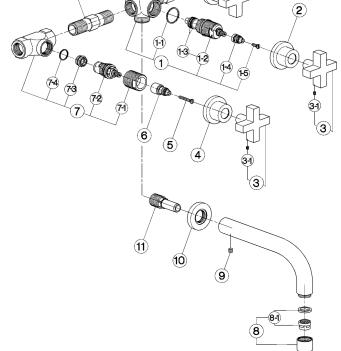
con resistenza silenziosa della classe di portata C (30 l/min. a 3 bar) with hydraulic resistance of flow rate class C (30 l/min. at 3 bar) mit geräuscharmen Widerstand der Durchflussklasse C (30 l/min. bei 3 bar) avec aérateur classe C (30 l/min. à 3 bar)
